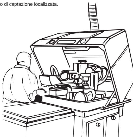
FIGURA 5 - Dispositivo di captazione avvolgente su una rettifica.
